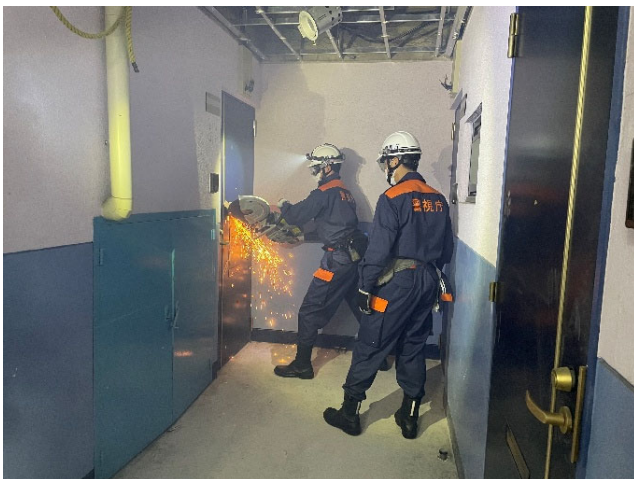
エンジンカッターで玄関ドアに穴を開ける様子
